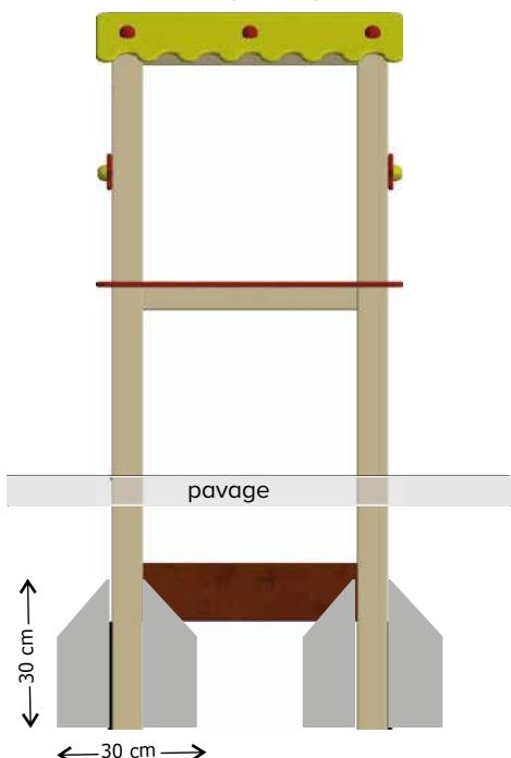
Fondation en stabilisé. Les poteaux sont aussi soutenus par les pavés ou klinkers.
